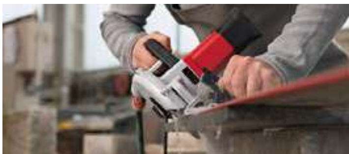
Traploze hoekinstelling voor verstekzaagsneden van 0 - 45°
